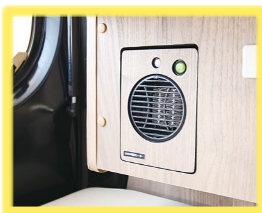
セラミックヒーター(暖房)はサブバッテリーで駆動。停車中でも使用可能な朝晩の肌寒い時に便利。
