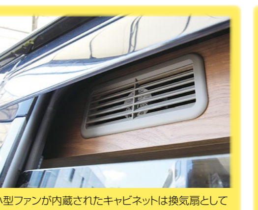
小型ファンが内蔵されたキャビネットは換気扇として機能します。窓を少し開放して車内の空気を循環させます。
