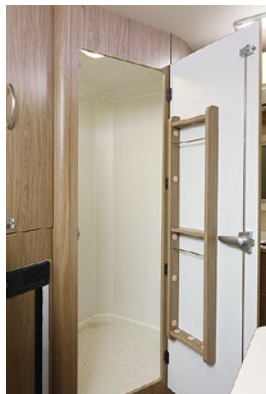
防水バン標準装備のフリールームにはポータブルトイレを置いたり、水に濡れたアイテムも収納可能です。(R2B)
