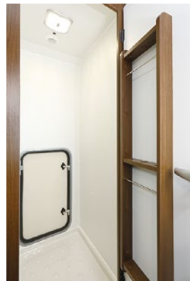
防水バン標準装備のフリールームにはポータブルトイレを置いたり、水に濡れたアイテムも収納可能です。(DC)
