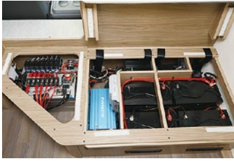
リチウムイオンバッテリーを採用したサブバッテリーは大容量の100A×4個。
