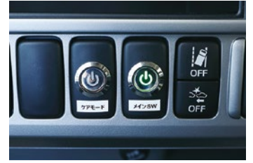
運転席からもキャンパー部電源を管理できるダブルメインスイッチを作用。
